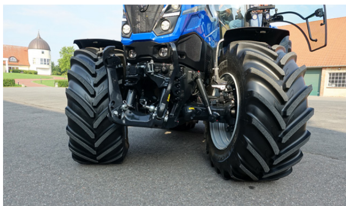
Il nuovo assale dei T7 a passo standard ha ridotto il raggio di sterzata del 17%, passando da 14,3 m a 11,4 m
