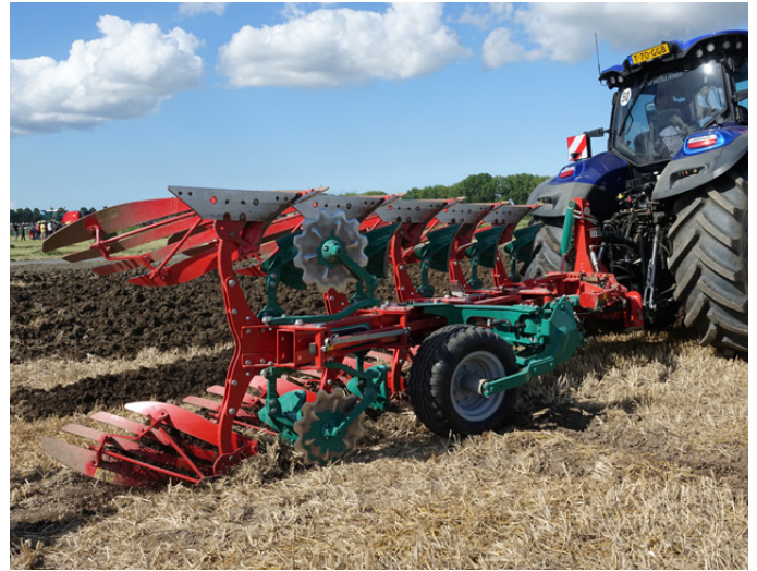
Nei nuovi aratri Variomat (nella foto il modello 3300 B) la ruota può essere collocata in posizione avanzata, per cui in occasione delle finiture dei campi o quando ci sono diversi ostacoli (per esempio i pali dell'alta tensione) la linea di aratura rimane sempre molto vicina all'ostacolo
