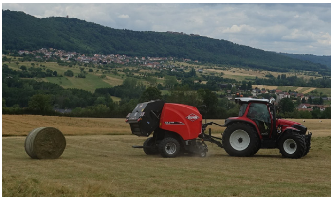
La camera di compressione dell'FB 3125 PowerTrack misura 1,22 x 1,25 m
