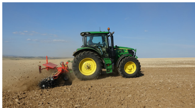
L'aggressività della sarchiatrice rompicrosta Starliner (nella foto il modello 620) dipende dalla regolazione delle ruote di livellamento in altezza e dalla velocità di lavoro
