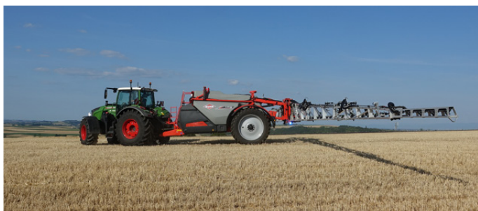
L'implementazione di Autoset nell'irroratrice Karan (nella foto il modello 6000) permette un riempimento del serbatoio a 900 l/min e una capacità d'irrorazione fino a 500 l/min
