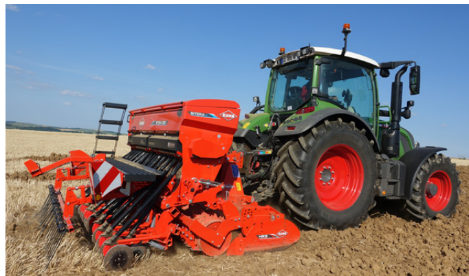
Le seminatrici della gamma Sitera 100 e (nella foto il modello 320 e) sono dotate di un dosatore ad azionamento elettrico
