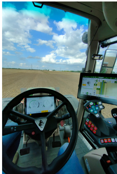
Dettaglio visuale cabina Fendt 516 Vario con scarico a scomparsa dietro il montante
