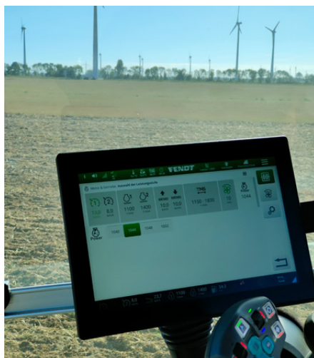
Controllo su monitor della potenza erogata sul Fendt 1052 Vario
