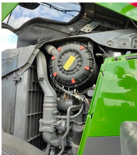
Primo piano del filtro aria autopulente sul Fendt 832 Vario
