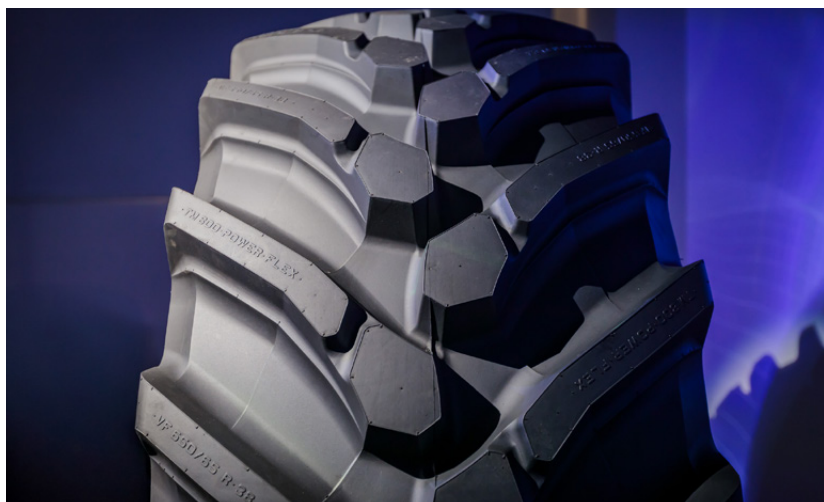
L'inserimento di una nervatura centrale ispirata alla geometria degli pneumatici stradali migliora la stabilità, la precisione di guida e il comfort durante i trasporti
