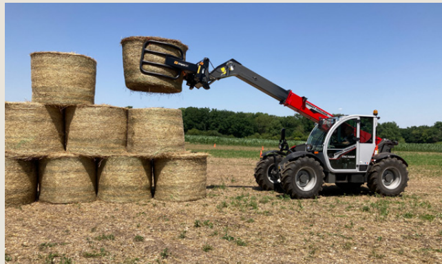
Tre modelli di telescopico TH sono disponibili con la nuova trasmissione Dyna Ct, un cambio a variazione continua che migliora le prestazioni del tradizionale idrostatico
