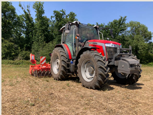
Con 145 cavalli e un passo di 2,62 metri, il 5M 145 estende la gamma degli utility MF
