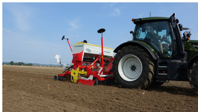
Associato a una seminatrice Pöttinger, l'erpice a dischi Fox 3000 D diventa una combinata per una semina economica, utilizzabile con trattori a partire da 80 cv
