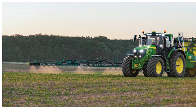
4- Il sistema See&Spray all'opera: si nota come siano aperti soltanto gli ugelli in corrispondenza delle infestanti rilevate tramite un'attenta analisi di immagine (Fonte: John Deere)
