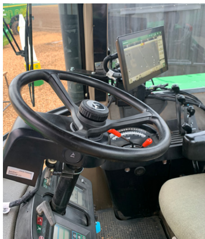
5 - La cabina del John Deere 4955, trattore che ha scritto la storia del marchio negli anni '90, nella quale è stato montato il sistema di guida AutoTrac con il relativo schermo G5 e il ricevitore Gps StarFire
