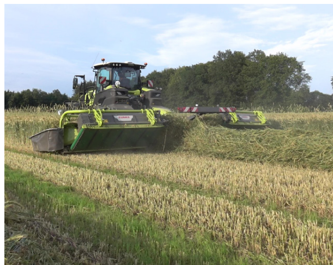
Disco 3200FRC Move con Disco 9300C Auto Swather al lavoro su triticale
