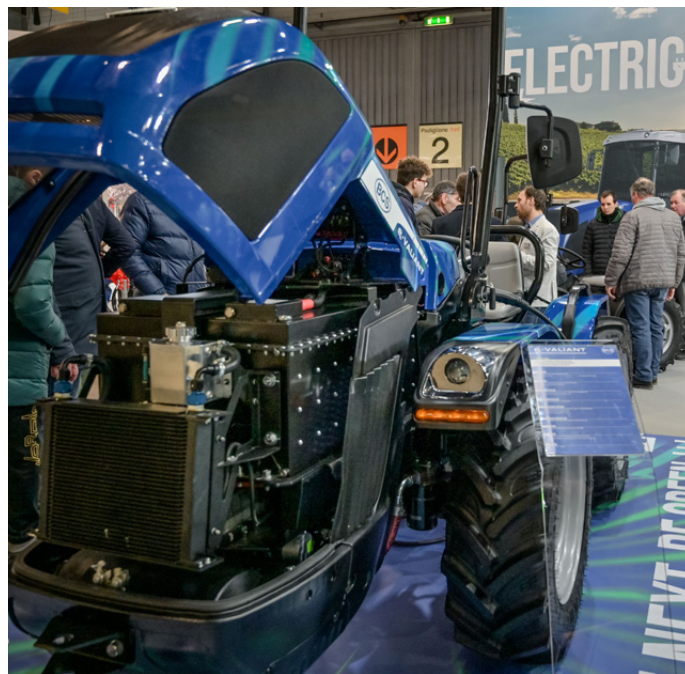
Le batterie al litio 48 V con capacità 30 kWh consentono una potenza elettrica totale installata di 40 kW
