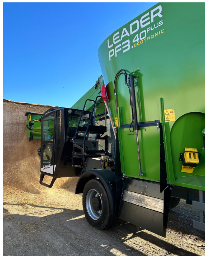
Rispetto alle versioni a due coclee, Leader PF3 monta una fresa maggiorata, larga ben 2.200 mm
