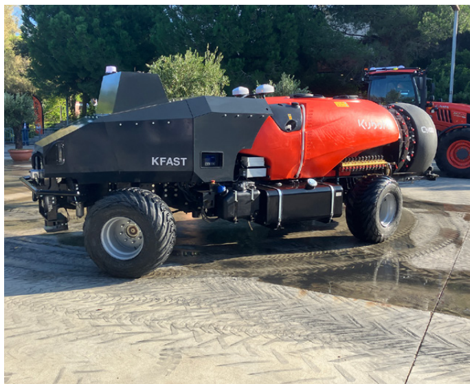
KFast, irroratrice autonoma per oliveti e frutteti a largo interfila
