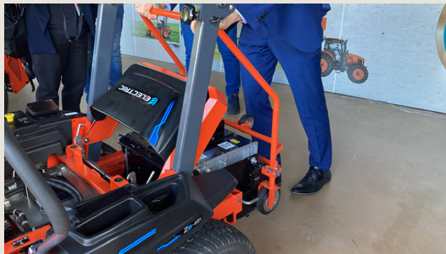
Estrazione delle batterie dal nuovo rasaerba elettrico ZE 481
