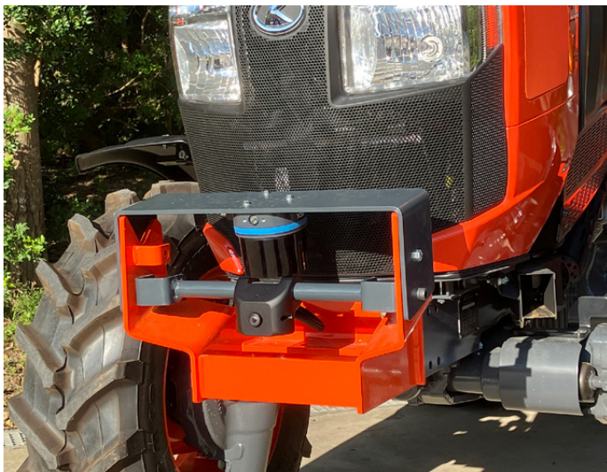
Sensore Lidar montato sul muso del M7 autonomo: è uno dei pochi elementi hardware necessari per robotizzare la macchina
