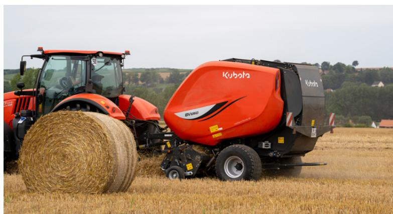
La rotopressa Kubota di nuova generazione a camera variabile è disponibile in due modelli, BV6160 e BV6190 (nella foto), rispettivamente in grado di produrre balle di 1,65 m e 1,85 m di diametro massimo
