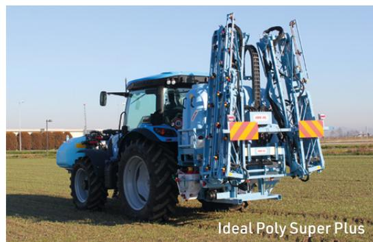
disponibile in versione portata con cisterne fino a 1.900 litri, per offrire la possibilità di lavorare su medio-ampie estensioni anche a chi ricerca un polverizzatore portato. Entrambi possono essere equipaggiati con barre idrauliche con caratteristiche diverse e ampie fino ai 21 m, nonché di una serie di accessori che ne facilitano l'uso e rendono il lavoro più semplice oltre che più sostenibile. ■
