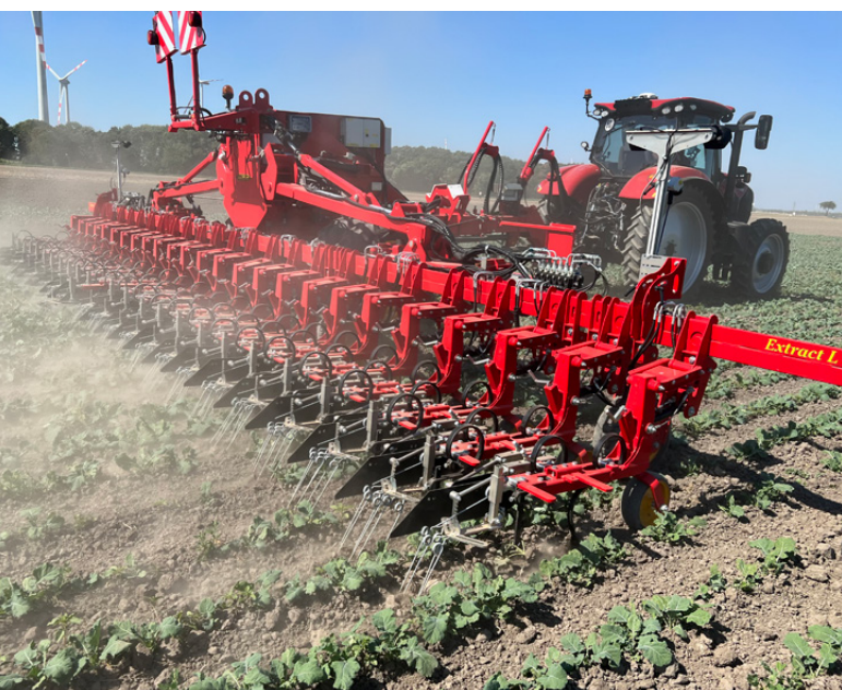
Coltivatore interfilare Extract con le telecamere laterali
