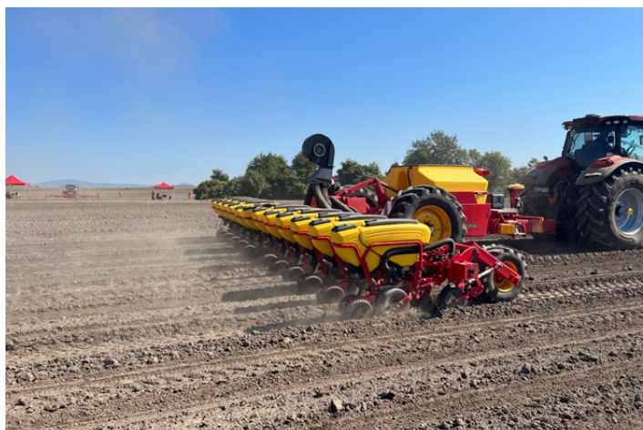
Tempo L con sistema di fertilizzazione liquido (sinistra) e Tempo V dove si possono apprezzare due delle dodici sezioni sollevate direttamente dalla cabina grazie al sistema di controllo delle sezioni (destra)
