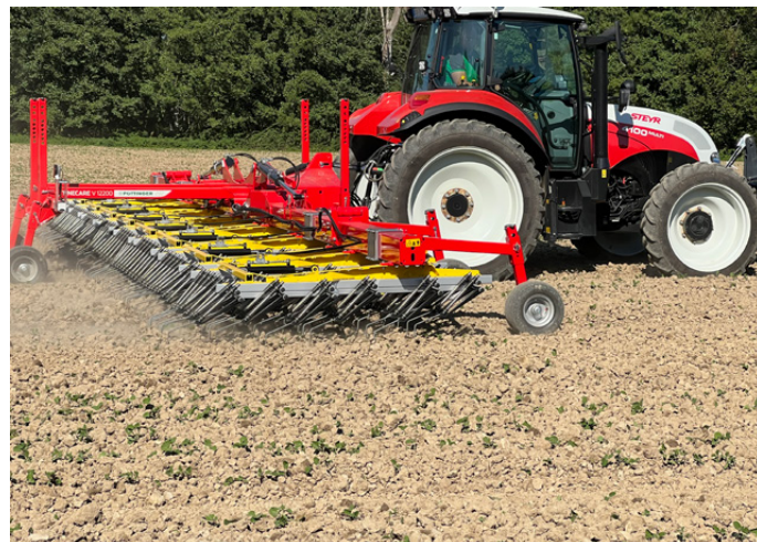
Il nuovo strigliatore Tinecare V 12200 in lavoro su campo di soia
