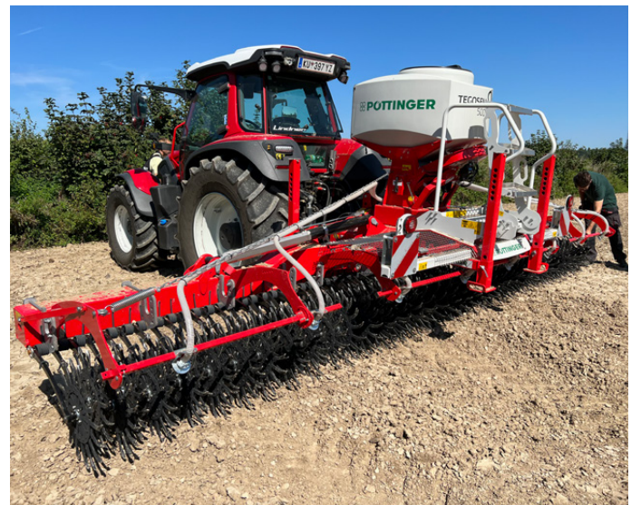
Il rompicrosta Rotocare V 6600 con il contenitore Tegosem 500
