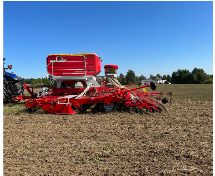
Seminatrice pneumatica Terrasem V 6000 in lavoro su terreno sodo
