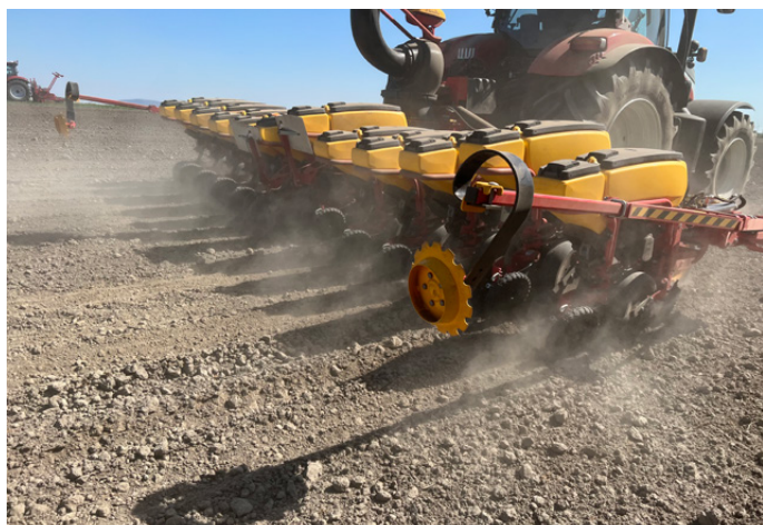
Tempo L con sistema di fertilizzazione liquido (sinistra) e Tempo V dove si possono apprezzare due delle dodici sezioni sollevate direttamente dalla cabina grazie al sistema di controllo delle sezioni (destra)
