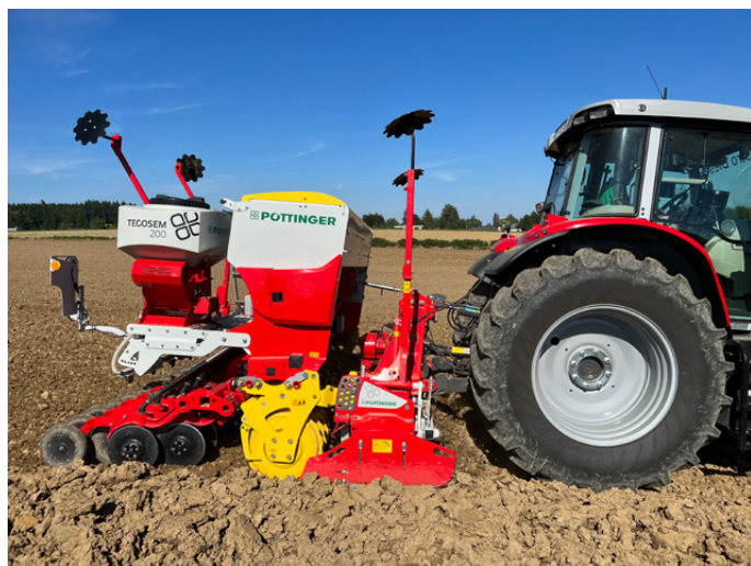
L'erpice rotante Lion 3030 in combinata con la seminatrice Vitasem M 3000 e contenitore per le sementi Tegosem 200 in lavoro su terreno arato
