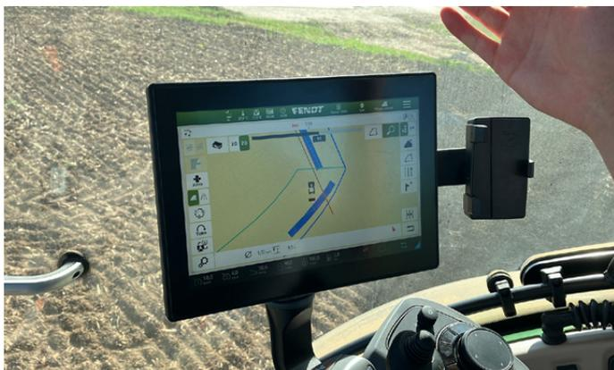
Con Coverage Guidance è possibile usare la guida automatica senza perimetrare il campo e senza registrare il percorso dal punto A al punto B, ma semplicemente iniziando a lavorare
