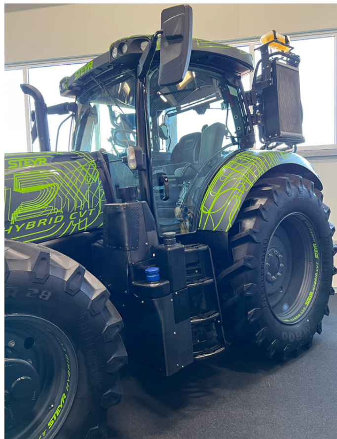
Il dettaglio del posizionamento provvisorio del sistema di raffreddamento delle componenti elettriche sopra al parafango posteriore sinistro
