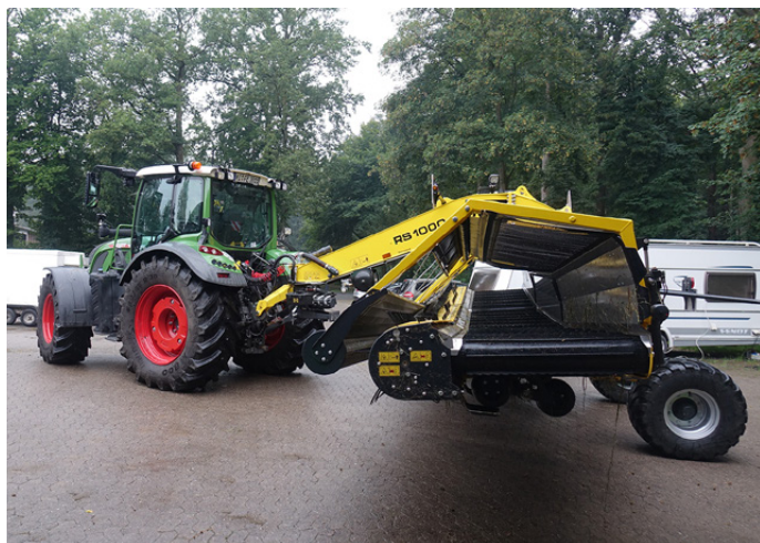
In Germania Kverneland ha anche presentato un nuovo modello di andanatore a tappeto della Roc, l'RS 1000, caratterizzato da un rullo dal particolare design, richiesto dai mercati nordeuropei e progettato per colture basse, ovvero sotto i 20-25 cm
