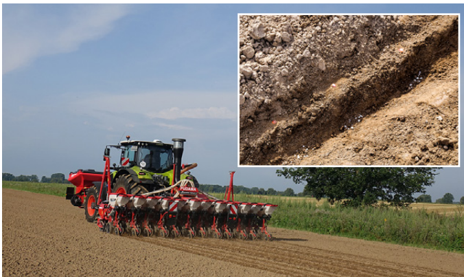
Seminatrice Optima SX con elemento Pudama. Nel riquadro visualizzazione del posizionamento del concime in prossimità del seme
