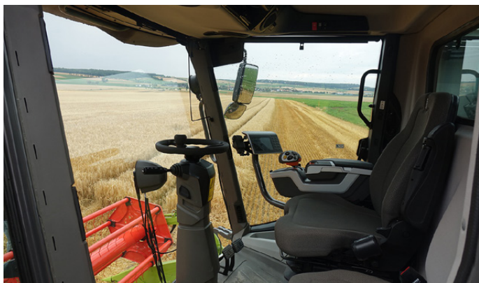
La cabina delle Evion è spaziosa, con climatizzatore, sedile a sospensione pneumatica e bracciolo di comando ergonomico, inclusi Cemis 700 e Cmotion
