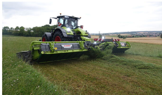
Prestazioni elevate per la nuova Disco 9700 RC Auto Swather con condizionatore a rulli e formazione di andana per la raccolta di erba medica e biomassa
