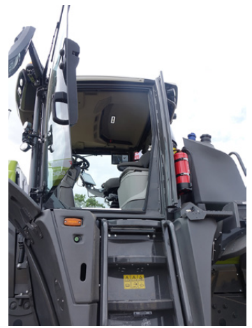
La cabina sospesa degli Xerion 12 su quattro punti con una perfetta visuale a 360°
