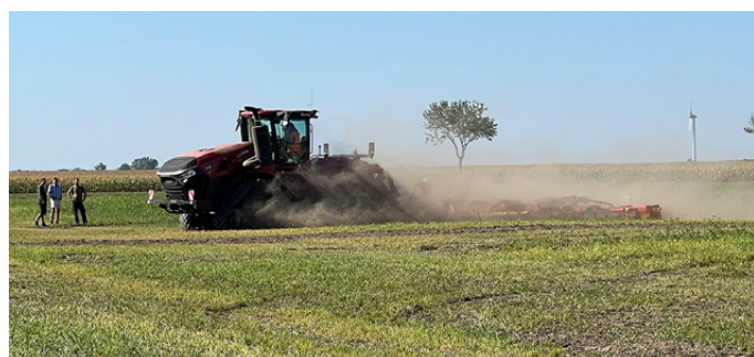
L'imponente Quadtrac 715 in lavoro con coltivatore semiportato Väderstad
