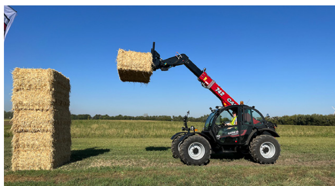
Il Farmlifter 742 in versione 2024; si noti come l'oggetto sollevato rimanga sempre parallelo al suolo in condizioni di massima stabilità a qualsiasi altezza
