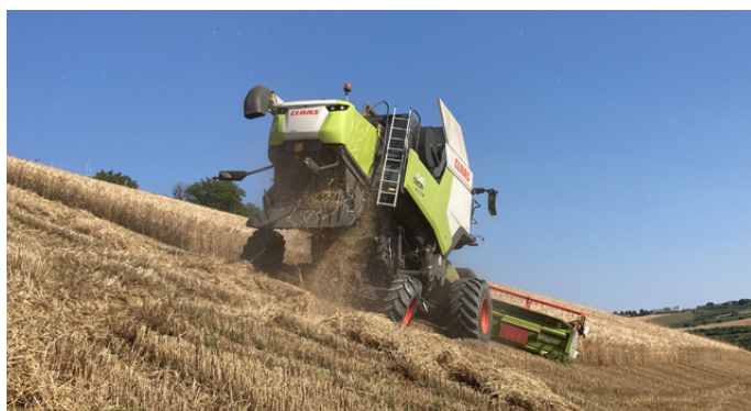
In questa immagine è ben visibile l'azione del sollevamento a pendolo, che riesce a mantenere le ruote posteriori sempre aderenti al terreno
