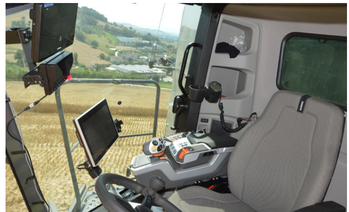
La Trion 540 Montana monta, come tutte le Trion, la nuova cabina, offerta dal 2022 anche sulle Lexion. Il bracciolo di comando è indipendente dal terminale Cebis ed è stato in parte rivisto. Tutti i comandi di livellamento sono integrati nel software principale
