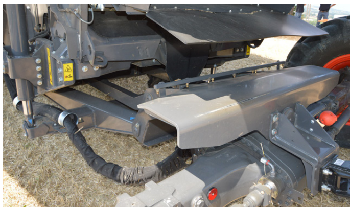
Il nuovo telaio imbullonato e irrobustito sostiene l'assale posteriore aumentando la sicurezza
