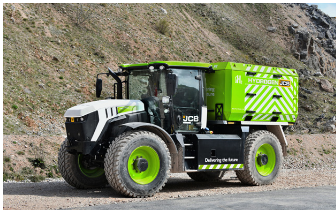
Il distributore di idrogeno può essere trasportato sul retro di un trattore Fastrac modificato
