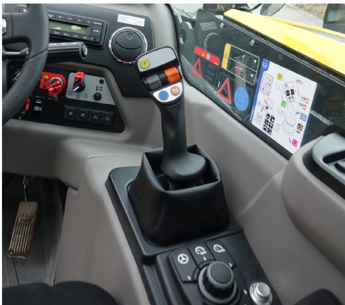
La nuova trasmissione è una Cvt idromeccanica a due marce con continuità di coppia tra 0 e 50 km/h
