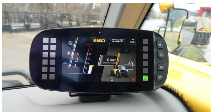
Tramite il display è possibile navigare all'interno del software veicolo modificando impostazioni e parametri della macchina
