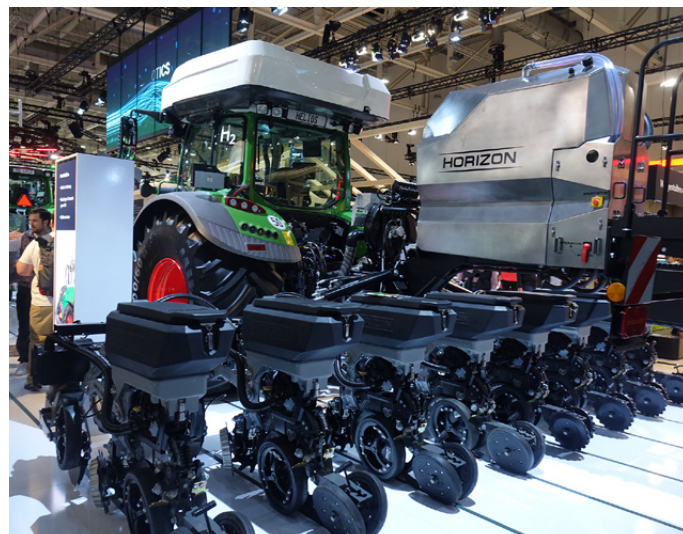
Il prototipo a idrogeno Helios di Fendt ad Hannover abbinato a una seminatrice da sodo Horizon
