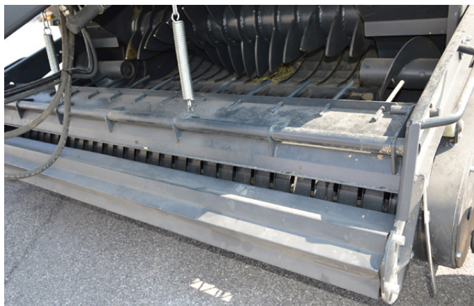
La macchina è stata ripensata da zero, con un pick-up senza camme
