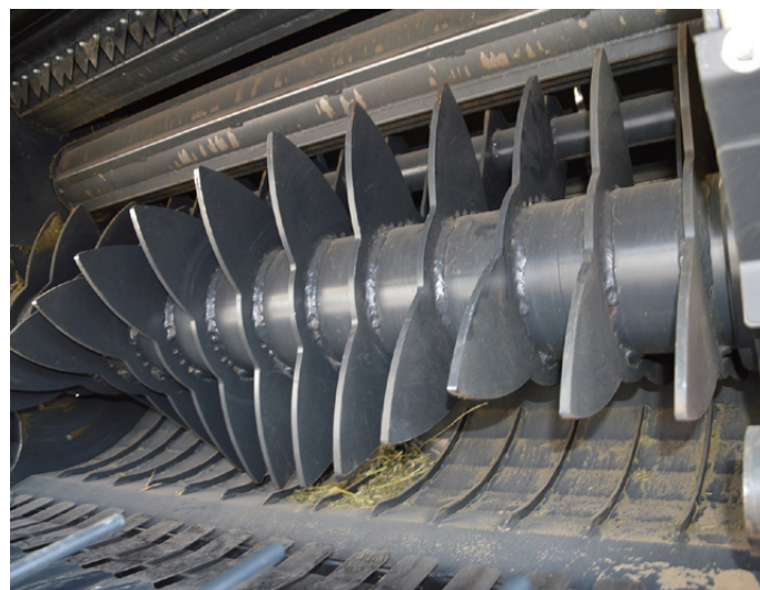
L'alimentazione a rotore può essere con o senza coltelli
