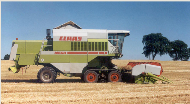
1994: modello prototipo con cingoli su Claas Mega
