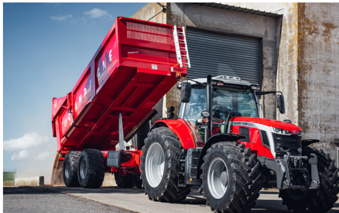
La massa massima ammessa dei nuovi MF 7S arriva fino a 14 tonnellate (nella foto l'MF 7S.190)
