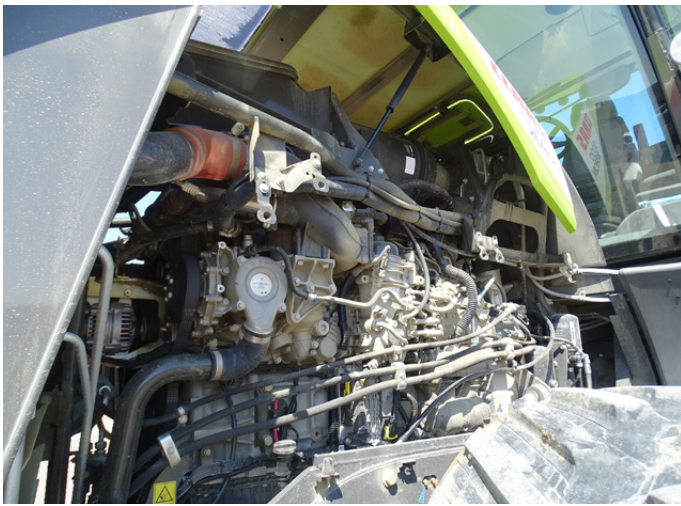
L'intervallo di manutenzione motore è di 1.000 ore, quello della parte idraulica è di 2.000 ore
