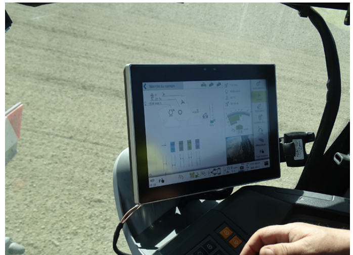
Con un attrezzo di 8 m di larghezza di lavoro, la velocità operativa va dai 15 ai 18 km/h come riportato dal Cebis in cabina
