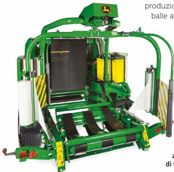
**Il sistema a tavola di trasporto (TTS) riceve la palla e la trasferisce in modo efficiente al sistema di fasciatura**
