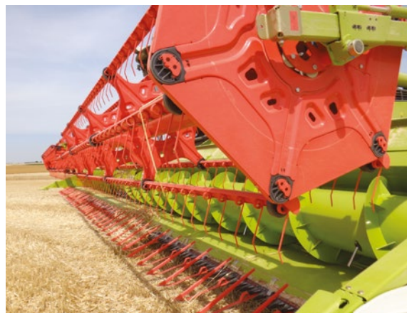
La sorprendente testata da 13,8 metri di lunghezza progettata per le Lexion 8900
