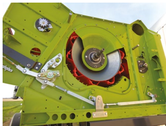
Il battitore da 75,5 cm è una delle novità più importanti sulle Lexion di II generazione
