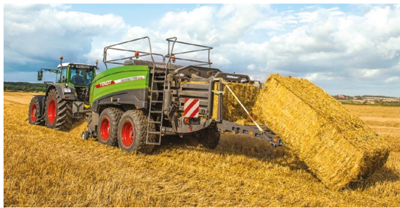
Sulla pressa Squadra è montato per la prima volta il sistema Intelligent Hay, un microchip direttamente nella balla
