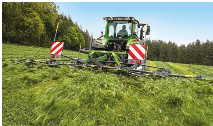
Lo spandivoltafieno Lotus è stato presentato a Marktoberdorf sia in versione portata che trainata
