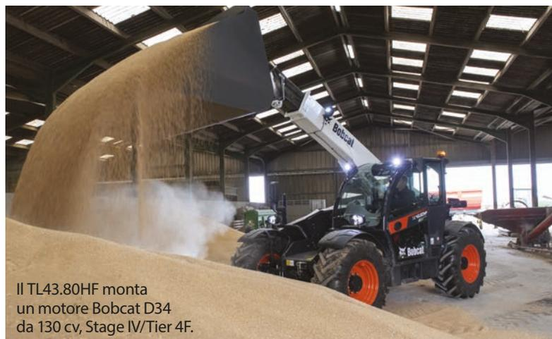
Il TL43.80HF monta un motore Bobcat D34 da 130 cv, Stage IV/Tier 4F.
