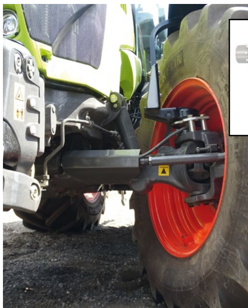
La nuova sospensione dell'assale anteriore ProActiv. Nel riquadro lo schema di funzionamento.
