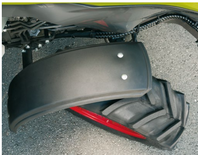
Il cofano a vite di vespa dei nuovi Nexos consente un ampio angolo di sterzata.
