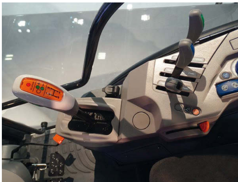
Primo piano della nuova trasmissione Argo Tractors, dotata di inversore meccanico o idraulico e di 4 marce per 3 gamme.
