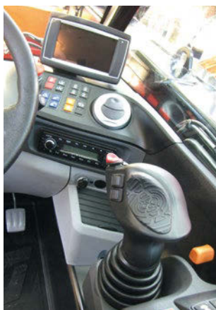
La rumorosità all'interno della cabina è stata ridotta a 73 dBA e il joystick Jsm è stato aggiornato.
