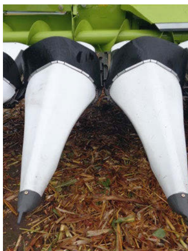
Il nuovo profilo "a cuffia" del Corio Conspeed.
