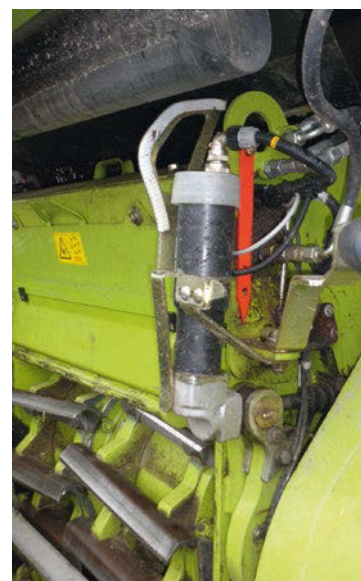
Il nuovo martinetto idraulico che blocca il perno del controcoltello, soluzione esclusiva di Claas
