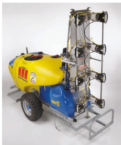
Nebulizzatore elettrostatico a flussi tangenziali M 612 Multi-Flow Südtirol 2015.
