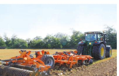
principale a struttura monotrave su cui sono posti tutti i vari elementi lavoranti. L'impiego del telaio con ruote centrali consente di ridurre la lunghezza complessiva dell'attrezzo a favore dell'impiego nel campo e della circolazione stradale.
