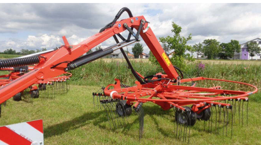
I rotori anteriori dell'andatore Ga sono sospesi su bracci idraulici.
