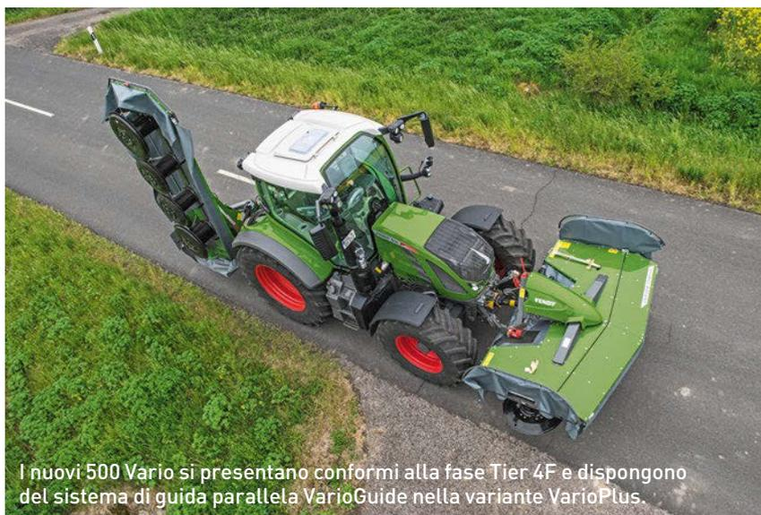
I nuovi 500 Vario si presentano conformi alla fase Tier 4F e dispongono del sistema di guida parallela VarioGuide nella variante VarioPlus.
