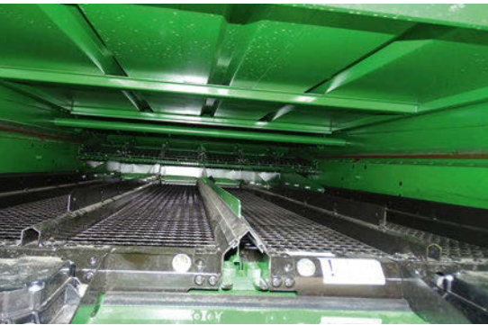
Area di separazione attiva e area della superficie dei crivelli nelle serie W e T sono state aumentate e sono oggi le più ampie sul mercato, sostiene JD.
